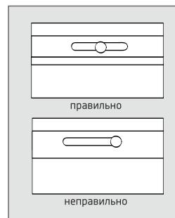
Длина панели, стыкующейся с аксессуаром должна предусматривать зазор на сжатие-расширение – 3-6 мм до края стены.
