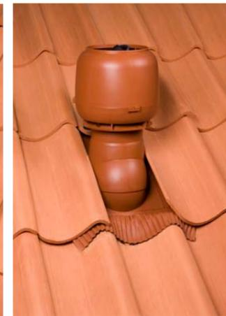
**RUS:** Установить на место снятые черепички. У некоторых видов черепицы надо немного сточить нижнюю поверхность для более ровной установки на обрешетку. На проходной элемент установить трубу, проверив вертикальность установки уровнем. Трубу закрепить к проходному элементу 6 шурупами.
