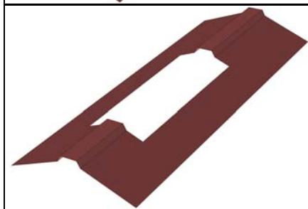
Вырезать по контуру отверстие ножницами для металла.
