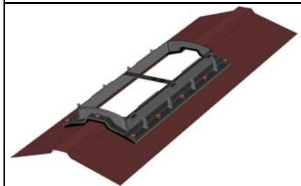
Закрепить шурупами рамку уплотнителя к коньковому элементу.
