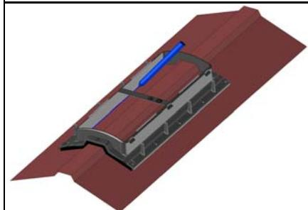
Очертить на коньке контур отверстия, используя рамку уплотнителя в качестве шаблона.
