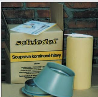
41 «Комплект для монтажа верхней части дымовой трубы» с готовой покрывной плитой включает: керамическую трубу, распорное кольцо, конус, герметик, уплотнительную массу и наглядную инструкцию по монтажу. При использовании готовых элементов для монтажа верхней части дымовой трубы консольная и покрывная плиты не устанавливаются.
