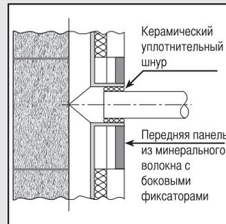
32 Зазор между внутренней поверхностью керамического тройника и трубой от потребителя уплотните керамическим шнуром.
