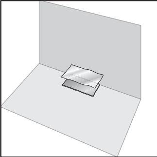
1 Подготовьте основание для установки цоколя. Для этого на увлажнённый пол уложите цементную подушку, выполните гидроизоляцию, нанесите цементный раствор.
