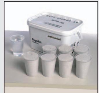
12 В случае применения сухой массы для заделки швов размещайте её точно в соответствии с прилагаемой инструкцией (7 частей массы и 1 часть воды). Последующие операции – см. рис. 13 и 14.
