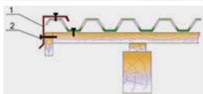
Рис.7. Крепление ветровой планки: 1 - «ветровая» планка; 2 - саморез
