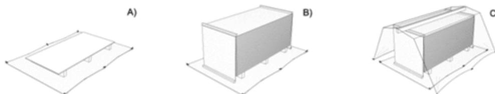
Перед использованием плиты на стройплощадке рекомендуется провести 24-х часовую акклиматизацию в новых условиях. В соответствии с правилами защиты и предохранения древесных материалов, влажность плиты во время монтажа не должна превышать 15 %. При таком уровне влажности исключается возможность появления грибов и плесени.
