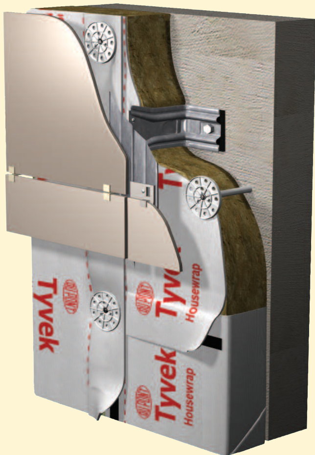
Рис. 9 Системы навесных вентилируемых фасадов
