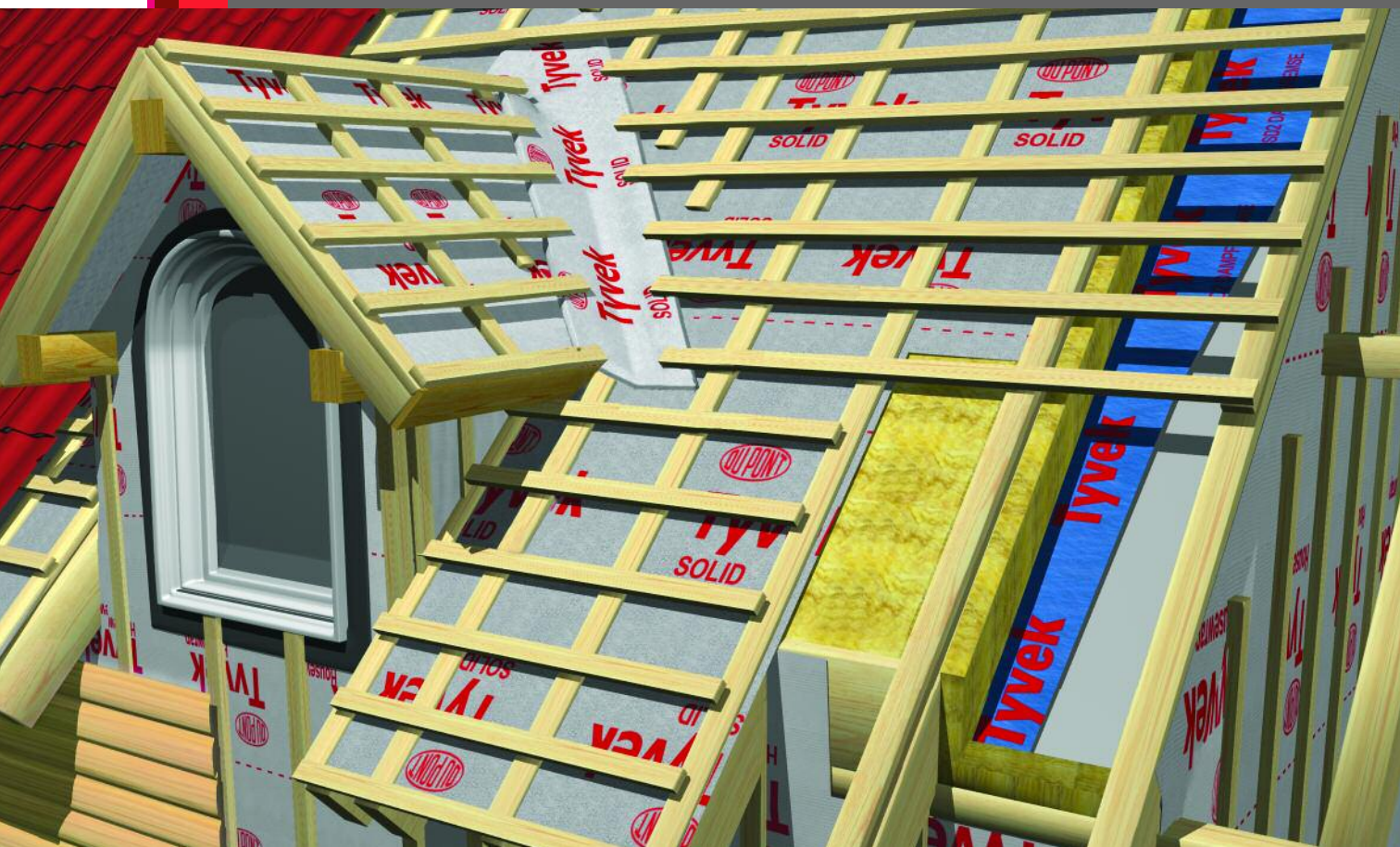
Рис.1 Устройство утепленной мансарды
