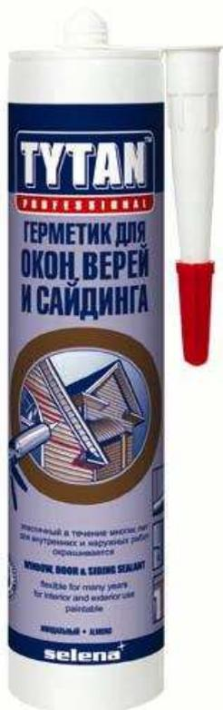
*Герметик для окон, дверей и сайдинга TYTAN* – это высококачественный герметик на основе силиконизированного акрила, предназначен для герметизации вокруг дверей, окон и сайдинга. Продукт рекомендован для всех швов, подверженных деформациям до  $\pm 12,5\%$ , особенно для внешних и внутренних соединений в местах с повышенным движением, обладает отличной адгезией к большинству строительных поверхностей:
