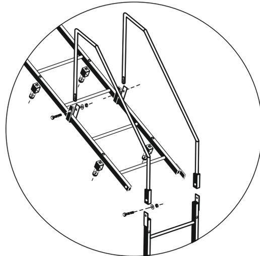
3. Собрать конструкцию в соответствии со схемой, закрепить опоры (2) к фасаду.
