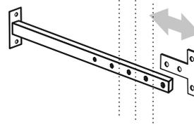
2. Разметить на фасаде места креплений опор (2) так, чтобы поручни (4) стыковались с кровельной лестницей и Т-образные накладки (3) совпали с отверстиями на фасадной лестнице.
